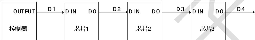
其中D1为控制器发送的数据，D2、D3、D4为级联TM1804转发的数据。
