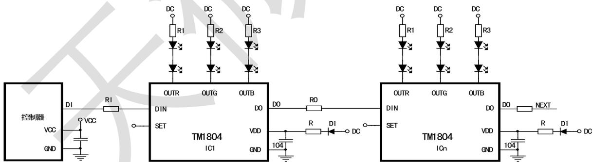
R1, R2, R3 的阻值可根据 OUT 端口串接的 LED 个数来自行调节。RI 与 R0 建议接 100~200 欧姆电阻，作信号隔离用，防止下一级芯片损坏后对上一级造成影响。
